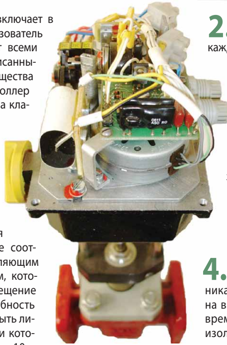
Рис. 4 Клапан КЗР-80Р с установленным в его приводе контроллером (вид сверху)
