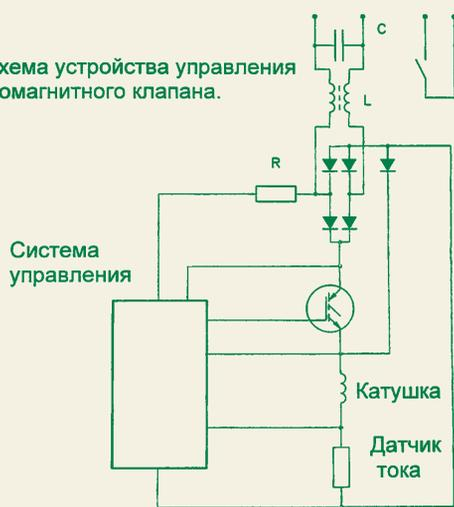
Рис. 1. Блок-схема транзисторно-микроконтроллерного устройства
